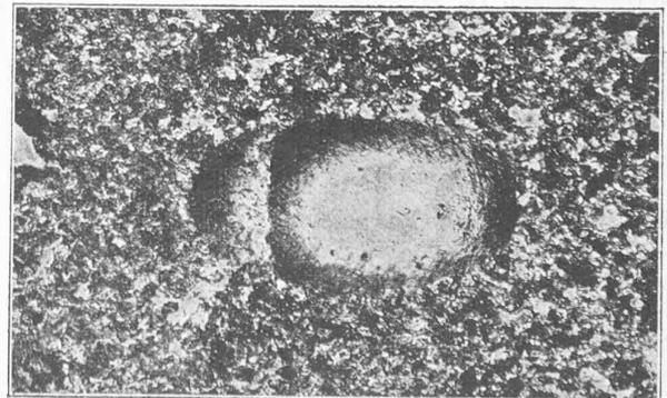
Fig. 2. — Empreinte à l'essai d'amplitude, grossie 100 fois.
