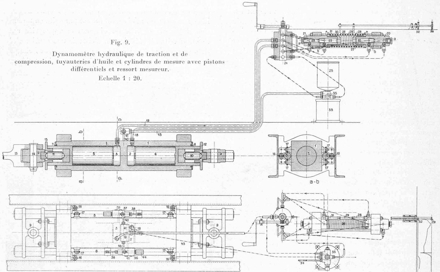
les degrés de sensibilité de 21 000, 10 500 et 7000 kg. Plus tard, l'introduction de la traction électrique a nécessité d'élever la capacité d'enregistrement maximum à 30 000 respectivement 15 000 et 10 000 kg. A cet effet il a fallu remplacer le ressort de mesure des pistons mesureurs par
