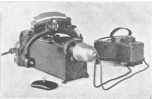
Fig. 1. — Dispositif *Herbert* pour la mesure de la capacité d'écroissage des métaux en fonction de la température.
