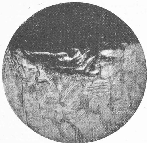
Fig. 4. — Bronze d'aluminium écroui à froid
