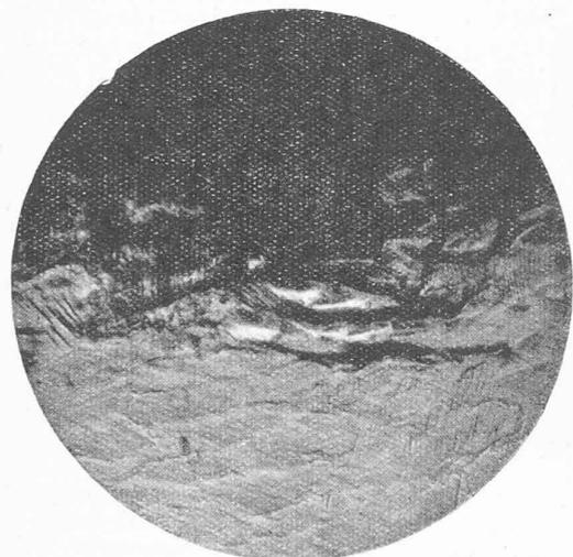
Fig. 5. — Bronze d'aluminium écroui à 48° C.
