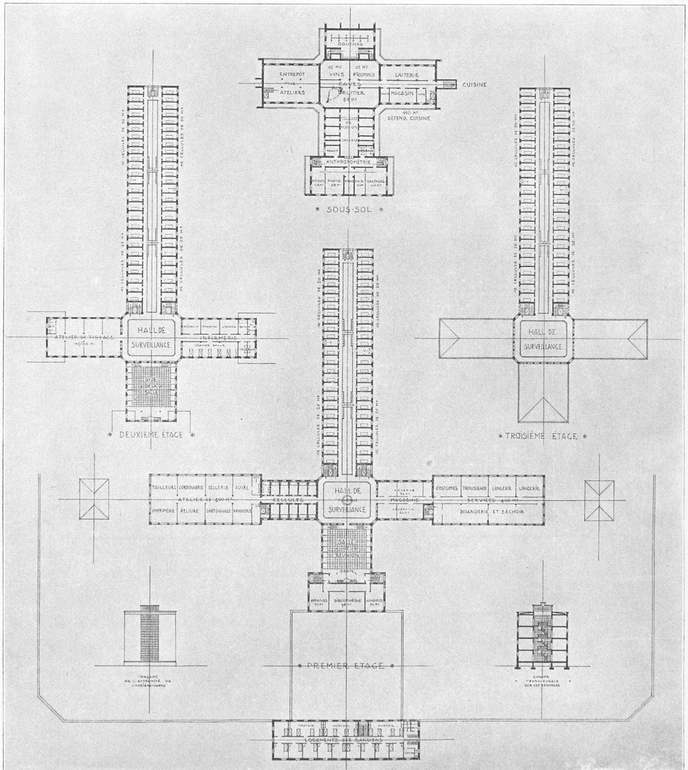
Plan du sous-sol, du 1<sup>er</sup>, du 2<sup>me</sup> et du 3<sup>me</sup> étage. — 1 : 1000.2<sup>me</sup> prix : projet « Carcer Labor », de M. A. Laverrière, architecte, à Lausanne.
