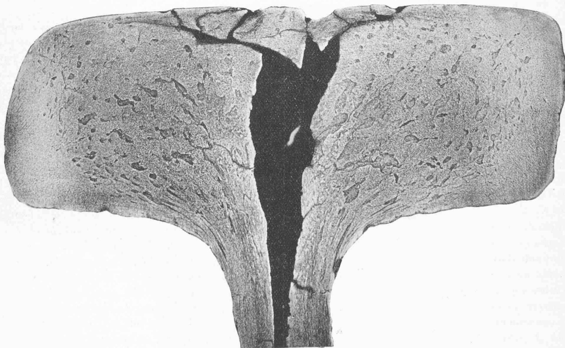
Fig. 8. — Macrographie montrant la formation de la lamelle d'exfoliation par la bifurcation de la cassure interne à la rencontre du métal plus sain, près de la table de roulement.
