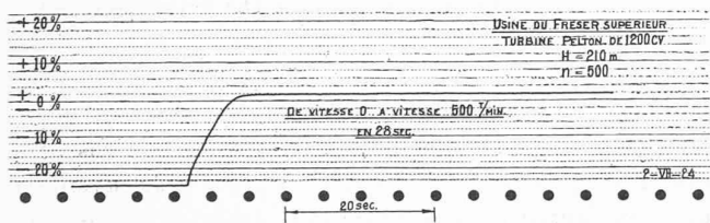
Fig. 7. — Mise en marche avec réglage automatique.
