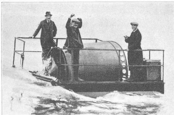
Fig. 3. — Turbine Suess, à moitié immergée.
