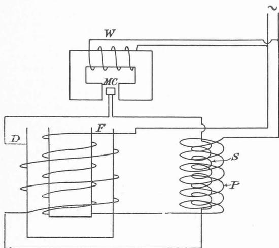
Fig. 1. — Schéma du four électrique à magnétomètre, Wild-Barfield.
