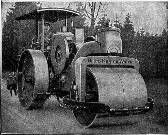
Plus grande économie d'entretien et de carburant : Consommation env. 20 kg. d'huile lourde par 10 heures de travail. Réduction des frais d'entretien jusqu'à 70% sur benzine, benzol, ou vapeur. **Construction la plus perfectionnée. Mise en marche immédiate, départ silencieux et sans secousses.**
