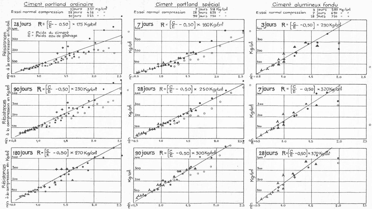
Cubes de 79m de côté Durcissement dans l'eau à +15°C
