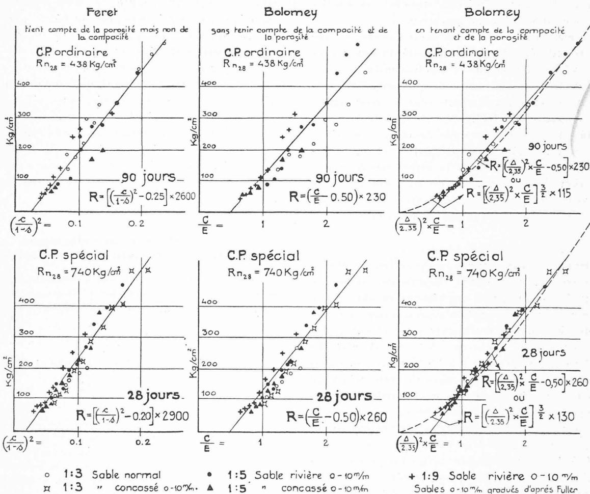
autre méthode. Elles permettent de calculer à 10 % près les résistances probables des divers mortiers et bétons et conviennent par suite particulièrement bien pour l'évaluation du coefficient K de qualité du liant. Il suffit, en effet, de préparer quelques échantillons de mortiers ou de bétons dont on détermine exactement
