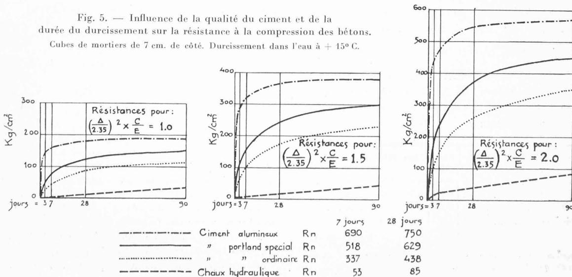
Les résultats ainsi obtenus sont au moins aussi précis que ceux fournis par la méthode usuelle, au mortier de sable normal damé à la machine.
