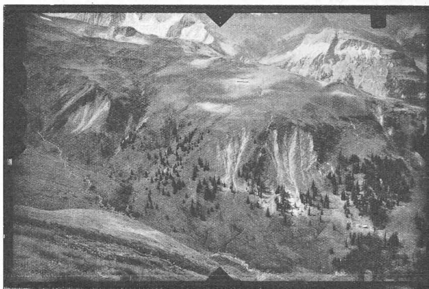
Fig. 5 et 6. — Mensuration cadastrale de Mels par stéréophotogrammétrie terrestre. Altitude : 2079,30 m. — Longueur de la base : 187,70 m.
