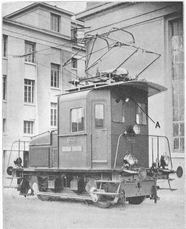
Fig. 10. — Locomotive de manœuvre des CFF., type Ee 2/2 .
