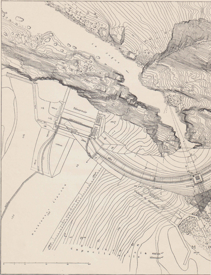
A gauche, le déversoir à clapet automatique remplacé, au moment de la surélévation du niveau du lac, à 800,80, par des cannes à secteur.
