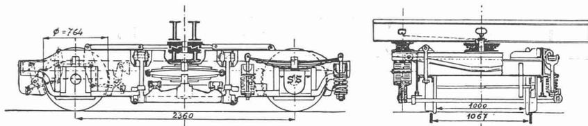
Fig. 2. — Bogie normal pour voitures des S.S.
