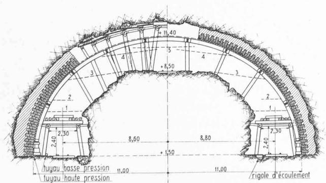
Fig. 11. — Exécution des maçonneries. — 1 : 300.
