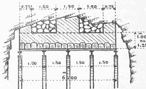
Fig. 14 — Profil longitudinal de la maçonnerie.
