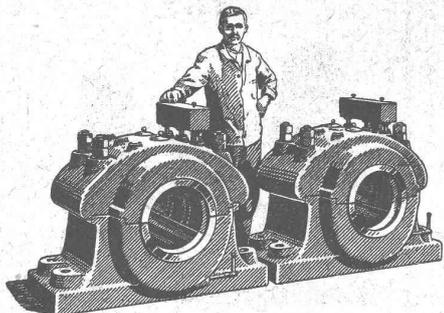
Paliers à patin, type lourd, de 350 mm. d'alésage, à graissage à bagues et circulations p<sup>r</sup> 360 tours/min.
