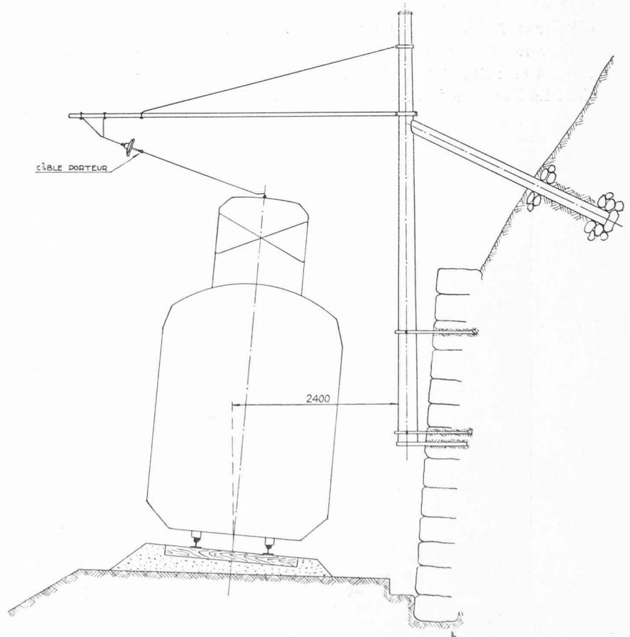
Fig. 8. — Suspension du fil de contact, en courbe.
