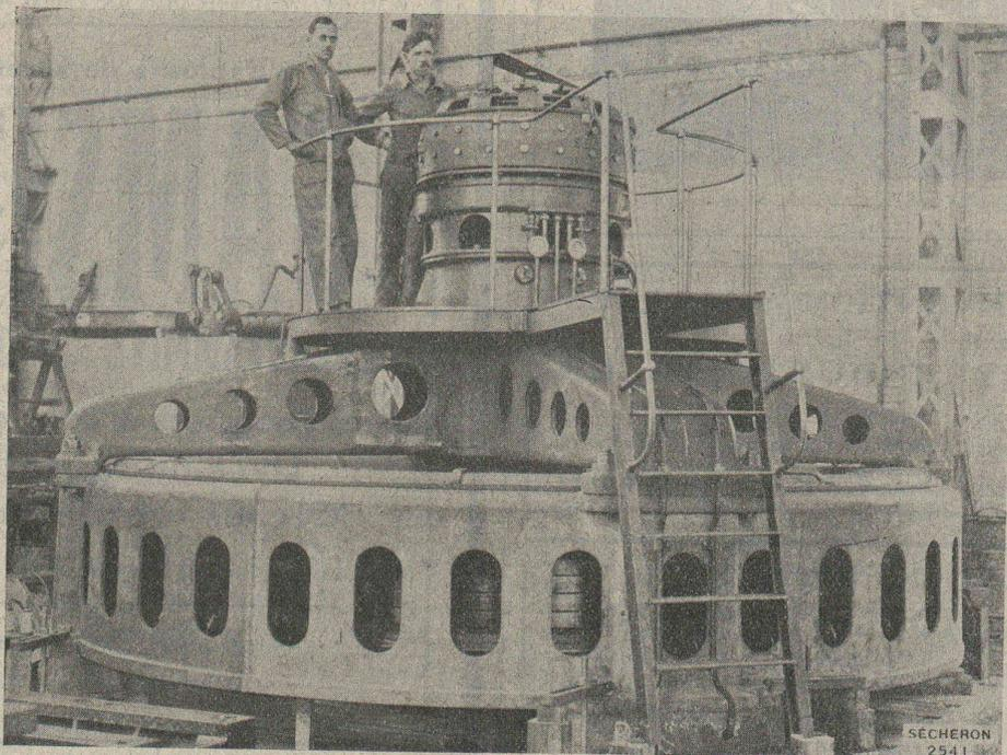
*Alternateur triphasé à axe vertical 1500 kvA, 9500 Volts,
