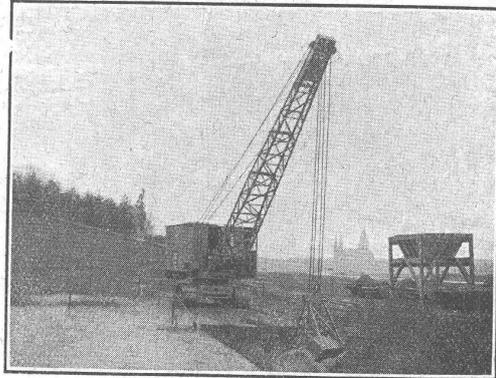
La PELLE MENCK DIESEL, grâce à la rapidité de manœuvre de ses accouplements, donne une grande vitesse de travail et peut être utilisée comme PELLE, EXCAVATEUR A GRAPPIN, DRAGLINE, GRUE et SONNETTE. Elle ne connaît pas d'arrêt et
