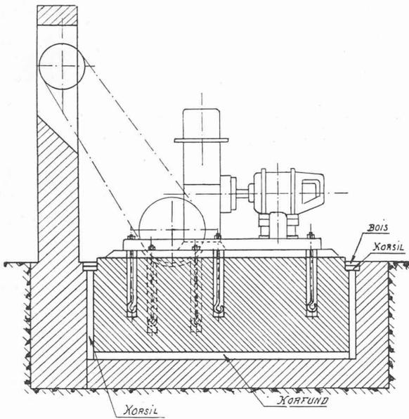
Fig. 12. — Isolation du massif de fondation d'une machine.
