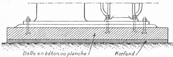
Fig. 13. — Isolation d'une machine sans massif de fondation.
