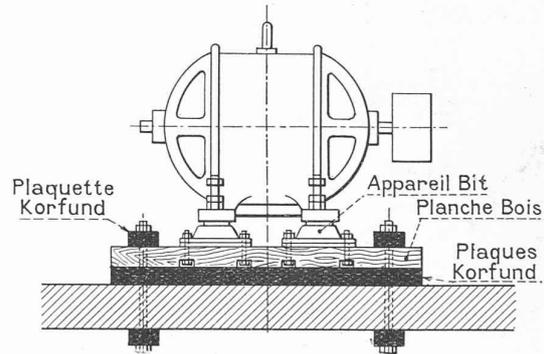
Fig. 14. — Isolation d'une machine au moyen d'appareils BIT.
