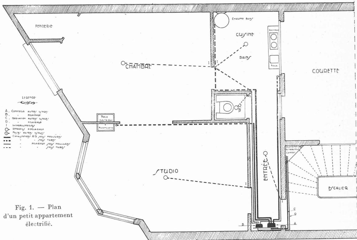
Fig. 1. — Plan d'un petit appartement électrifié.
