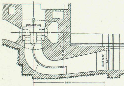
Fig. 11. — Diffuseur coudé de l'usine de Kachlet
