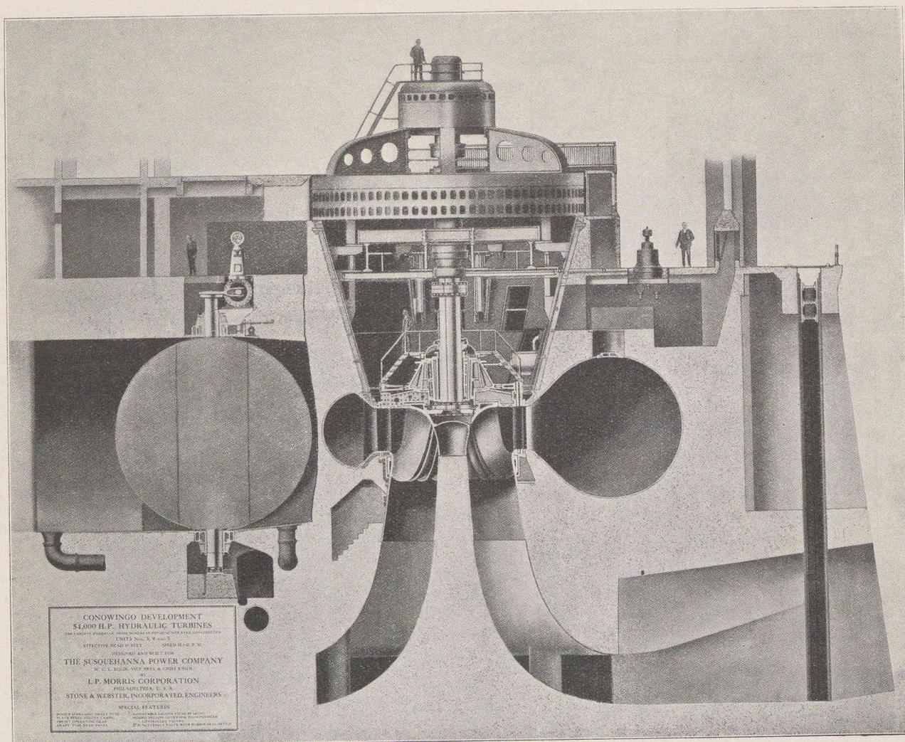
Fig. 3. — «Spreading Draft Tube» *Moody*
