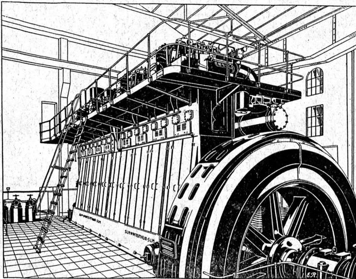
à injection mécanique et par insufflation, pour installations fixes, bateaux et locomotives.
