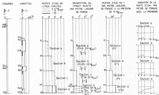
Barrage de Castillon. Graphique d'un forage exécuté par G. Rodio & C<sup>ie</sup>.
