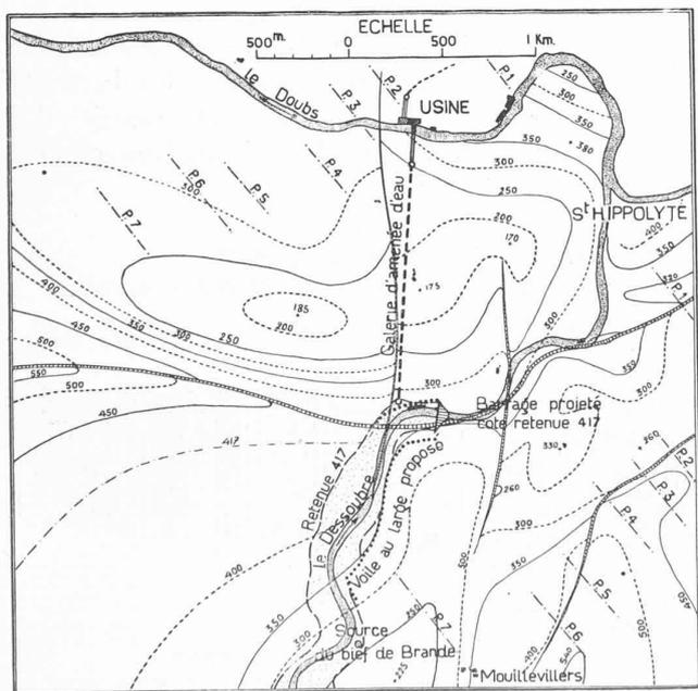
Surface hypsométrique de la marne liasique imperméable construite au moyen de sept coupes géologiques, elles-mêmes exécutées d'après une carte géologique levée spécialement au 1 : 20 000.
