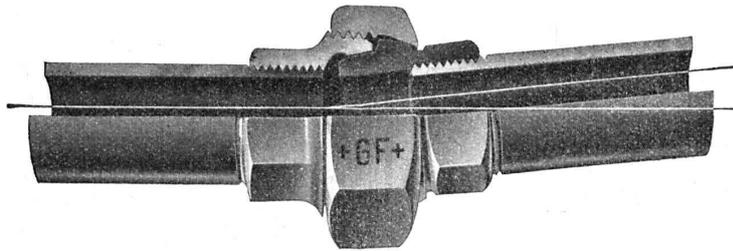
La jonction de tubes qui ne sont pas situés dans le prolongement l'un de l'autre qui ont des filetages inclinés ou qui doivent être raccordés suivant une ligne brisée, constitue un problème que le "raccord Mac" résoud de manière simple et élégante, permettant un désaxement jusqu'à 6°. Comme tous les raccords +GF+, il est éprouvé à l'usine à la pression hydraulique.
