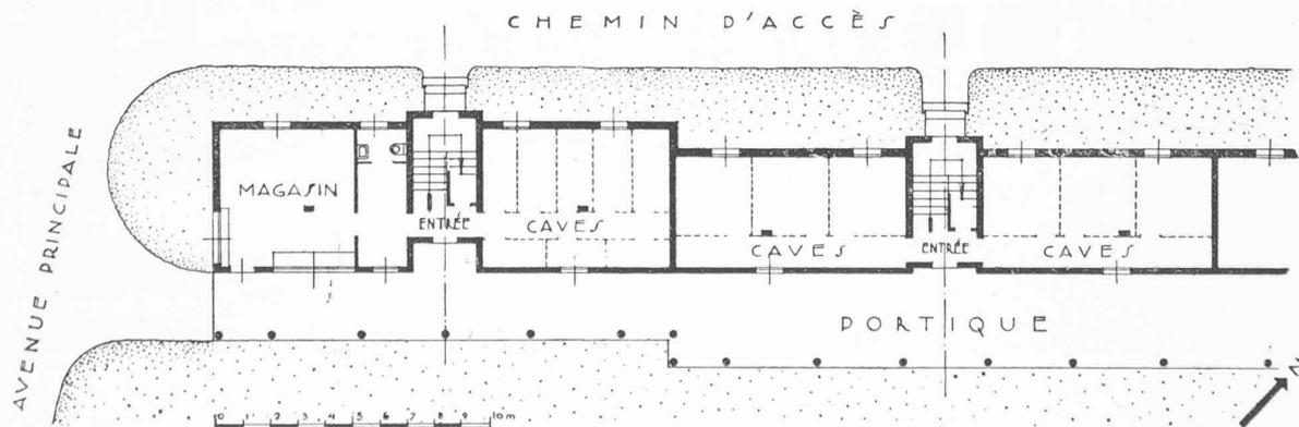
Fig. 4. — Plan du rez-de-chaussée.
