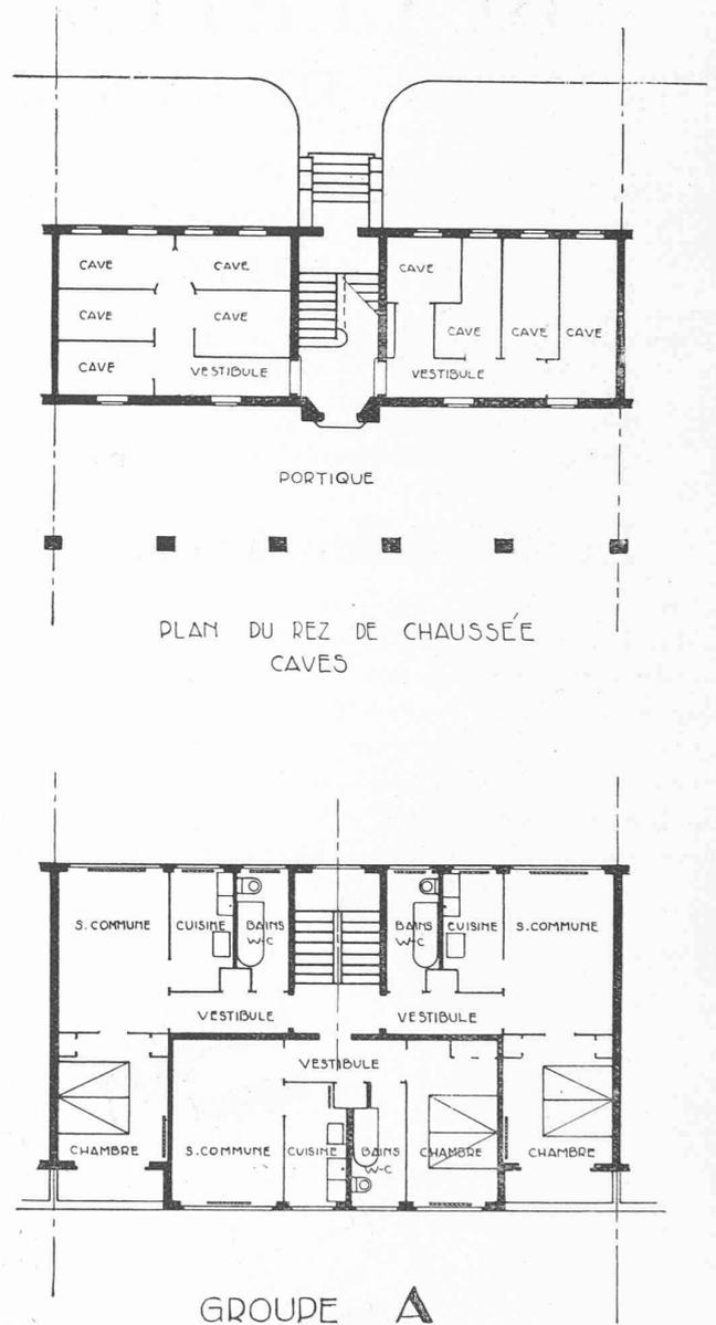
Fig. 2. — Plans du rez-de-chaussée et des étages.
