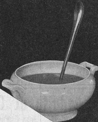
Le premier: sa grande stabilité, ses surfaces nettes, lisses, sans pores, faciles à polir. Le second: sa rapidité de fabrication: en quelques secondes, par une seule opération, ce manche de louche à soupe sort de la presse, avec sa forme cambrée et ses décors. Et le troisième avantage, le plus important: son prix réduit, dû au matriçage à chaud, procédé de fabrication très économique. Voulez-vous nous soumettre les pièces qui vous intéressent? Nous vous ferons les conditions les plus favorables.
