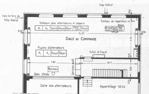
Fig. 41. — Disposition de la salle des tableaux.
