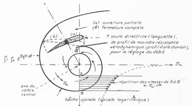
Fig. 3. — Coupe transversale de la bêche spirale.
