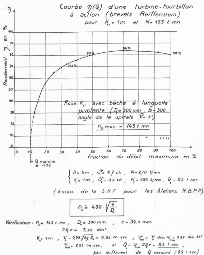
Fig. 5. — Rendement d'une turbine-tourbillon à action.
