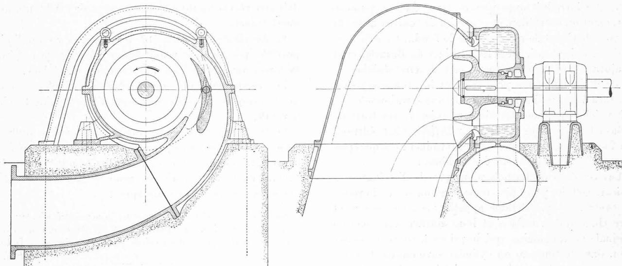
Fig. 4. — Dessin d'exécution d'une turbine-tourbillon à action.
