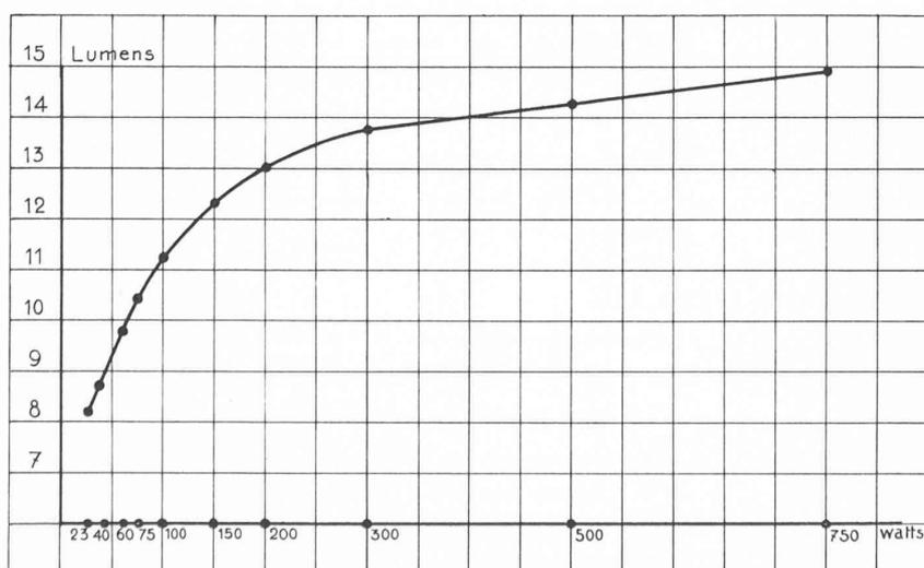
Fig. 2. — Efficacité lumineuse en fonction de la puissance des ampoules.
