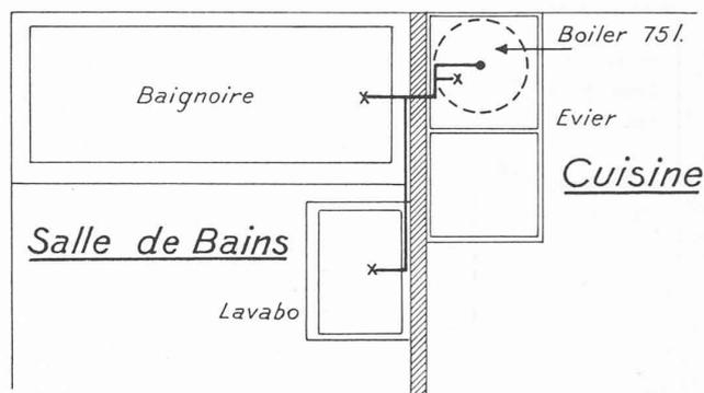
Fig. 11. — Trois postes d'eau chaude alimentés par un seul boiler.
