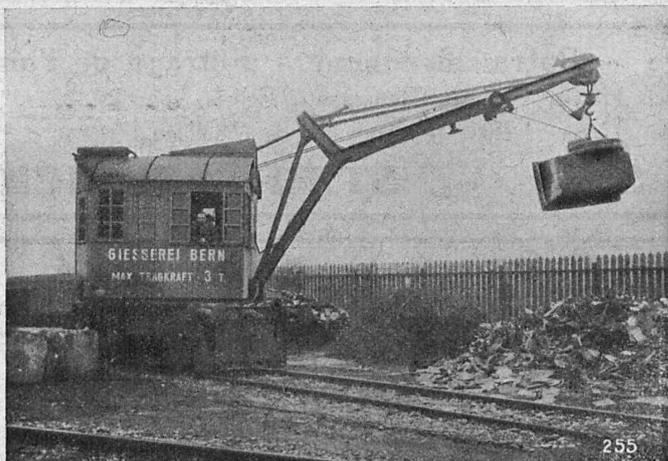
Grue pivotante de 3 tonnes pour service avec électro-aimant et avec benne preneuse automatique.
