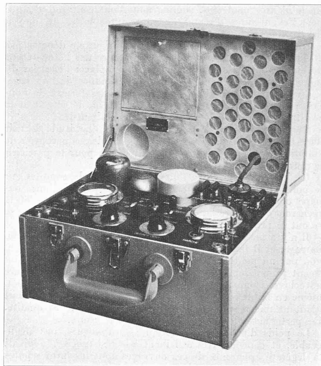
Fig. 2. — Amplificateur à lampes, pour « témoins sonores ».
