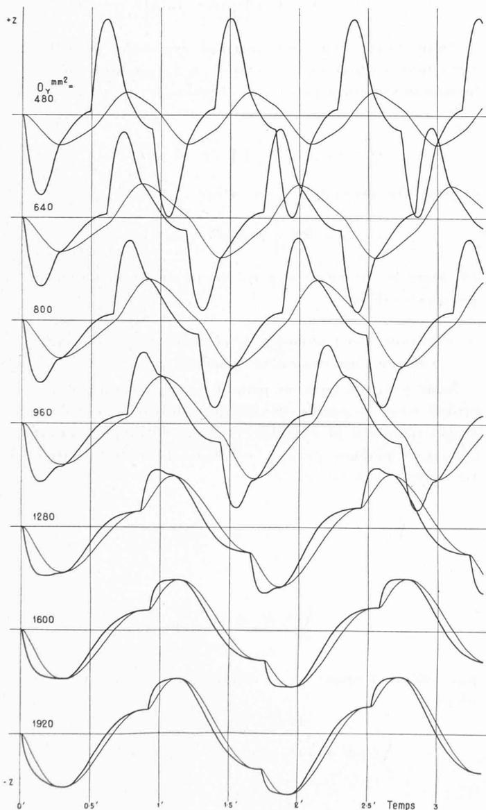
Fig. 27. — Manœuvres alternatives rythmiques type D entre 0 et 1 dm<sup>3</sup>/s. Rapidité de manœuvre de l'obturateur  $\xi_1 = 0,778 \text{ dm}^3/\text{s}^2$ .
