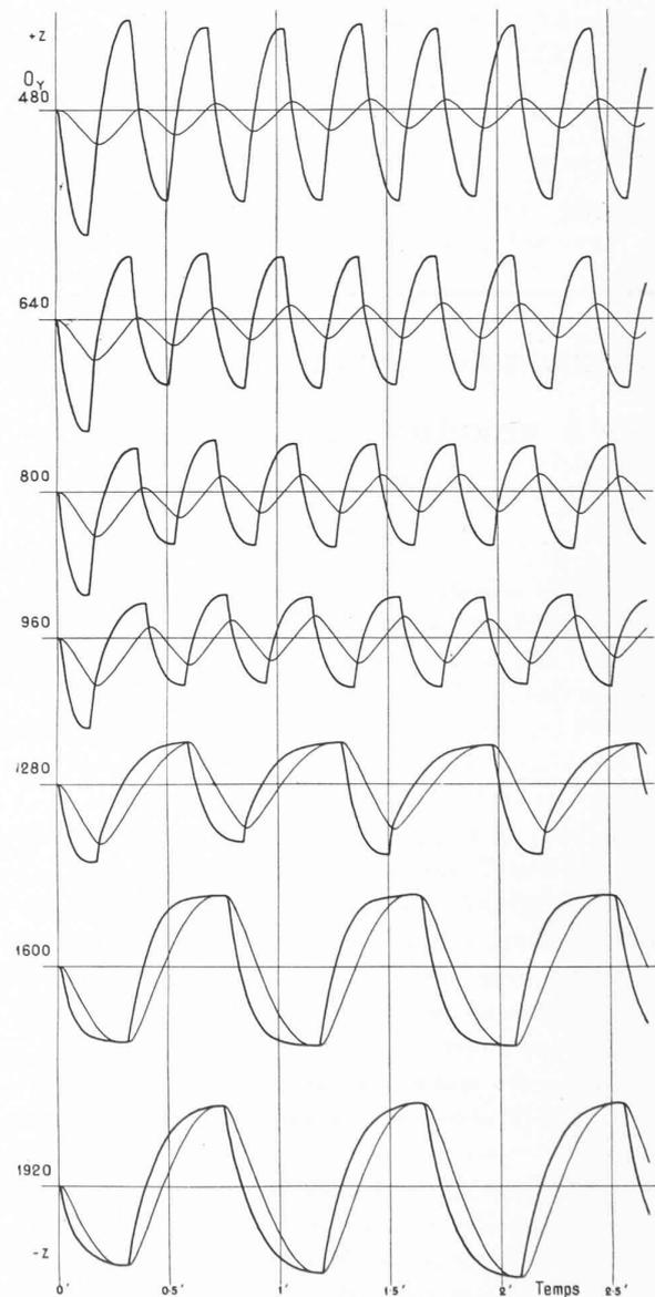
Fig. 26. — Manœuvres alternatives rythmiques type B entre 0 et 1 dm<sup>3</sup>/s. Rapidité de manœuvre de l'obturateur  $\xi_1 = 0,778$  dm<sup>3</sup>/s<sup>2</sup>. Galerie d'aménée de 101,74 m de longueur et de 150 mm de diamètre. Les sections respectives du tube et du réservoir sont de 403 et 1578 cm<sup>2</sup>.
