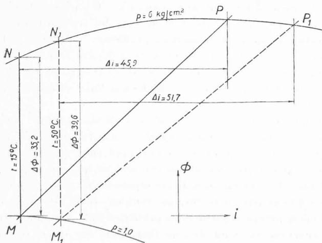
Fig. 4. — Compressions isothermique et isentropique de l'air représentées dans le diagramme  $i - \Phi$ .
