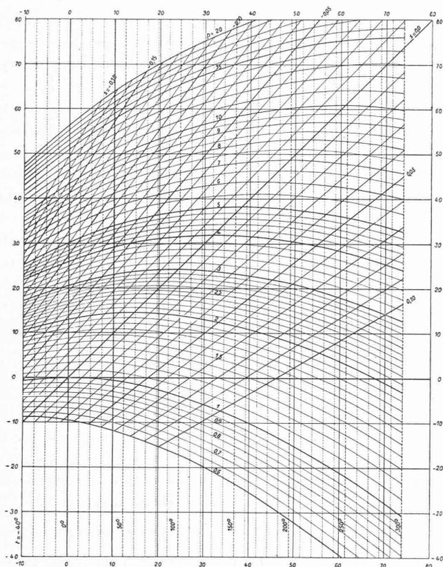
Fig. 3. — Reproduction du diagramme  $i-\Phi$  pour l'air atmosphérique.
