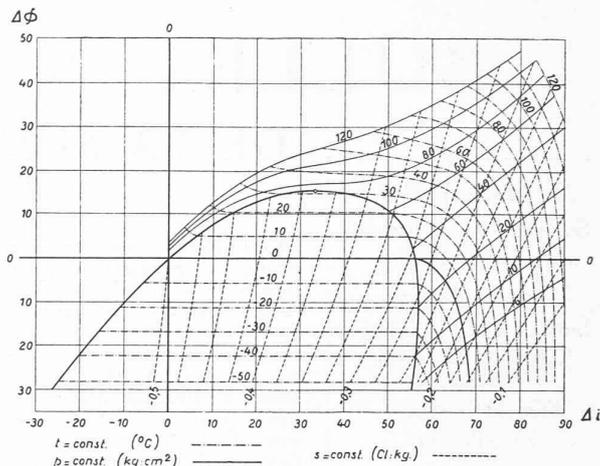
Fig. 2. — Reproduction du diagramme  $i-\Phi$  pour l'anhydride carbonique.
