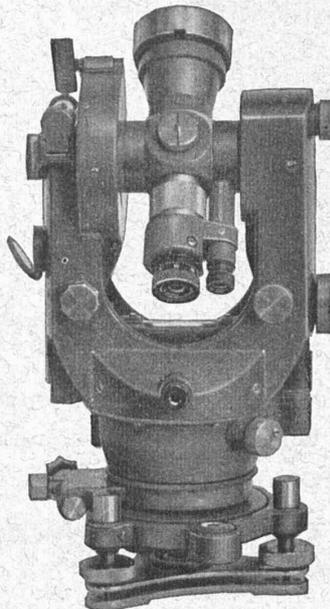
Le changement le plus important dans ce nouveau modèle se réfère à la stabilité de l'instrument qui a été augmentée en remplaçant les paliers de métal léger par des paliers en bronze.
