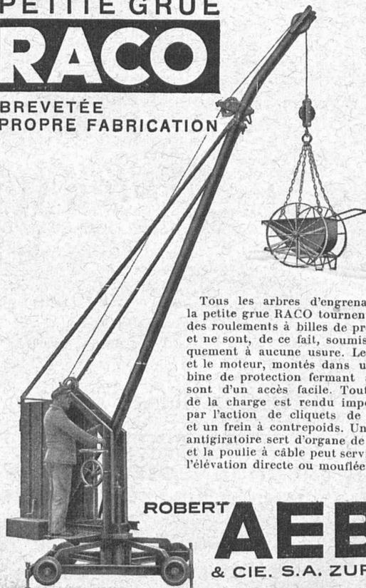
Tous les arbres d'engrenage de la petite grue RACO tournent dans des roulements à billes de précision et ne sont, de ce fait, soumis pratiquement à aucune usure. Le treuil et le moteur, montés dans une cabine de protection fermant à clef, sont d'un accès facile. Tout recul de la charge est rendu impossible par l'action de cliquets de sûreté et un frein à contrepoids. Un câble antigiratoire sert d'organe de levage et la poulie à câble peut servir pour l'élévation directe ou mouflée.
