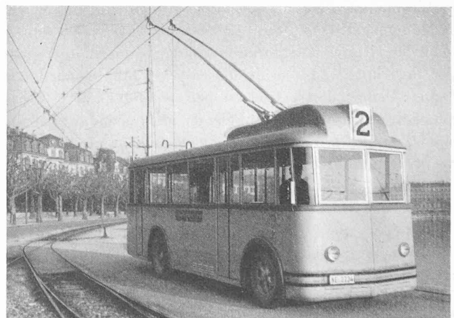
Fig. 1. — Voiture rentrant au dépôt, ligne aérienne avec croisement tramway-trolleybus.
