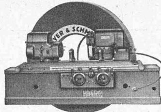
Machines à rectifier à commande hydraulique
