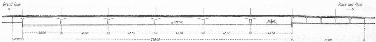
Fig. 3. — Pont du Mont-Blanc. — Elévation. — Echelle 1 : 2000
