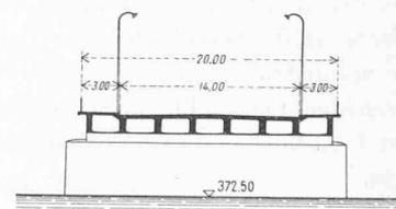
Fig. 14. — Pont des Bergues. — Coupe transversale. Echelle 1 : 600.
