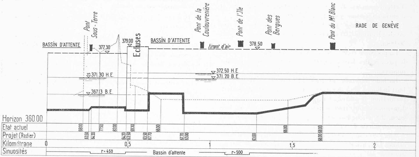
Fig. 2. — Bief navigable. — Profil en long. — Echelles : longueurs 1 : 12500, hauteurs 1 : 500.
