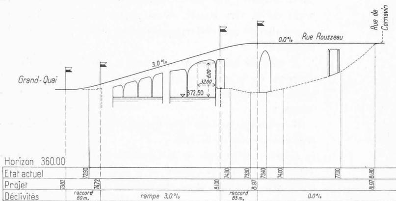
Fig. 6. — Pont des Bergues. — Profil en long. — Echelles : longueurs 1 : 6000, hauteurs 1 : 600.
