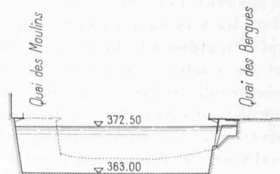
Fig. 15. — Quai des Bergues. — Profil en travers. Echelle 1 : 1000.
