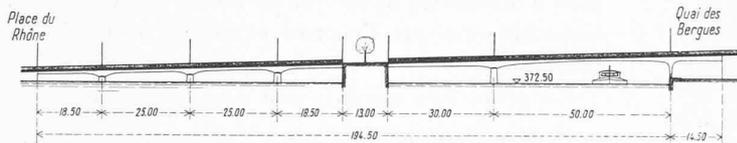
Fig. 5. — Pont des Bergues. — Elévation. — Echelle 1 : 2000.
