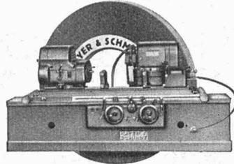
Machines à rectifier à commande hydraulique
