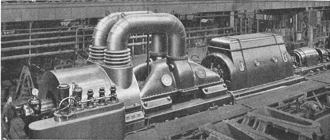
Groupe turbo-générateur à deux cylindres et condenseur axial
