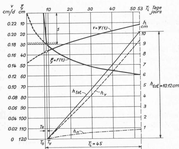
Fig. 35 b. — Calcul théorique du gonflement. Exemple n° 2,  $\xi_0 > H$ ; profondeur critique plus grande que celle de la nappe phréatique. b) Absorption d'eau, pénétration du gel et gonflement, en fonction du temps.
