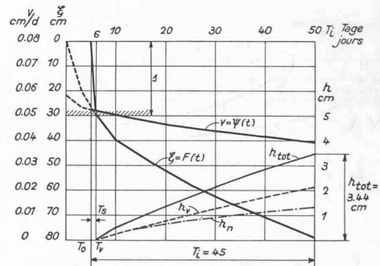
Fig. 34 b. — Calcul théorique du gonflement. Exemple n° 1,  $\xi_0 < H$ ; profondeur critique plus faible que celle de la nappe phréatique. b) Absorption d'eau, pénétration du gel et gonflement, en fonction du temps.
