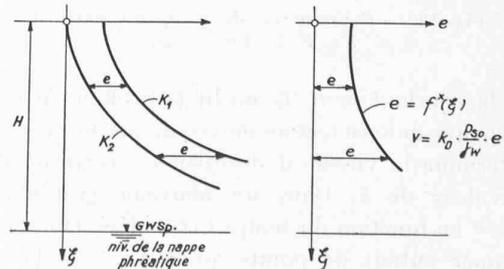
Fig. 32. — Valeur de  $e = K_1 - K_2$  en fonction de la profondeur de gel pour  $\xi_0 > H$ .
