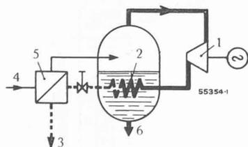
Fig. 3. — Schéma simplifié d'une pompe thermique à agent auxiliaire.
