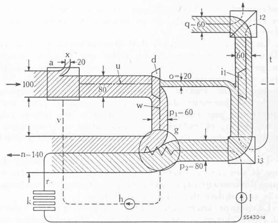
Fig. 13. — Diagramme d'écoulement de chaleur d'une installation comportant une turbine à contre-pression *d* avec condenseur de chauffage *g*, la turbine fournissant l'énergie mécanique nécessaire pour entraîner le compresseur d'une pompe thermique *i*<sub>1</sub> avec évaporateur *i*<sub>2</sub> et condenseur *i*<sub>3</sub>.
