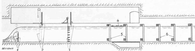
Fig. 3. — Chambre de jaugeage, disposition générale.
