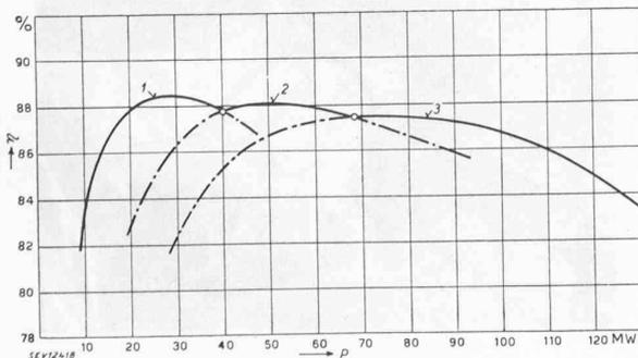
Fig. 10. — Rendement global de l'usine d'Innertkirchen, entre la prise d'eau du canal de fuite de l'usine de la Handeck et les appareils de fourniture d'énergie électrique sous tension de 150 kV.
