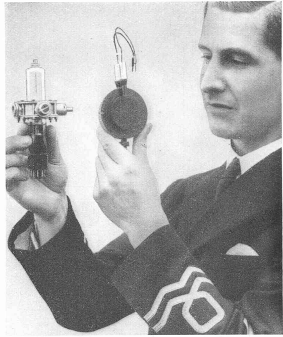
Fig. 11. — A droite, magnétron fournissant des puissances d'impulsion de l'ordre de 200 kW sur la longueur d'onde de 10 cm. A gauche, klystron à réflexion (dit tube de Sutton) utilisé comme oscillateur auxiliaire du récepteur. Le développement du tube à magnétron avec des puissances d'impulsion atteignant 1000 kW, de construction extrêmement condensée, ainsi que du klystron à réflexion ont constitué la base de la fabrication d'appareils Radar.
