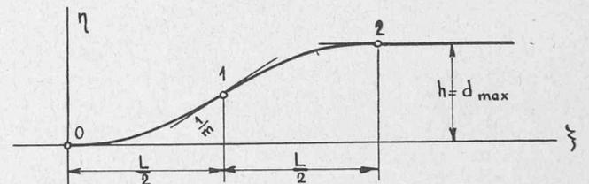
être tangente au point 0 à l'axe des  $\xi$  et au point 2 à une // à l'axe des  $\xi$ . Les points 0, 1 et 2 seront des points d'inflexion.
