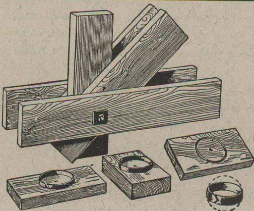
Ringdübel + Patent Assemblage de charpente en bois
