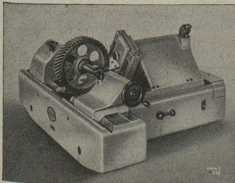
Appareil MAAG à mesurer l'angle d'hélice de
