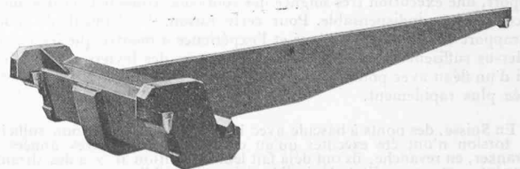
Fig. 18. — Leviers à torsion pour pont à bascule de 45 t à voie étroite et sans interruption de voie.
