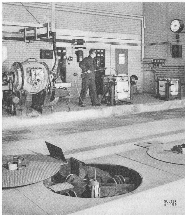
Fig. 5. — Coup d'œil dans la fonderie. Au premier plan, découverte, une machine à coulée centrifuge ; au fond, à gauche, un four à tambour chauffé par barreau de graphite ; à droite, deux fours à induction. Les températures des charges en fusion, mesurées par un couple thermoélectrique, sont lues directement au cadran visible au haut de la figure, à droite.
